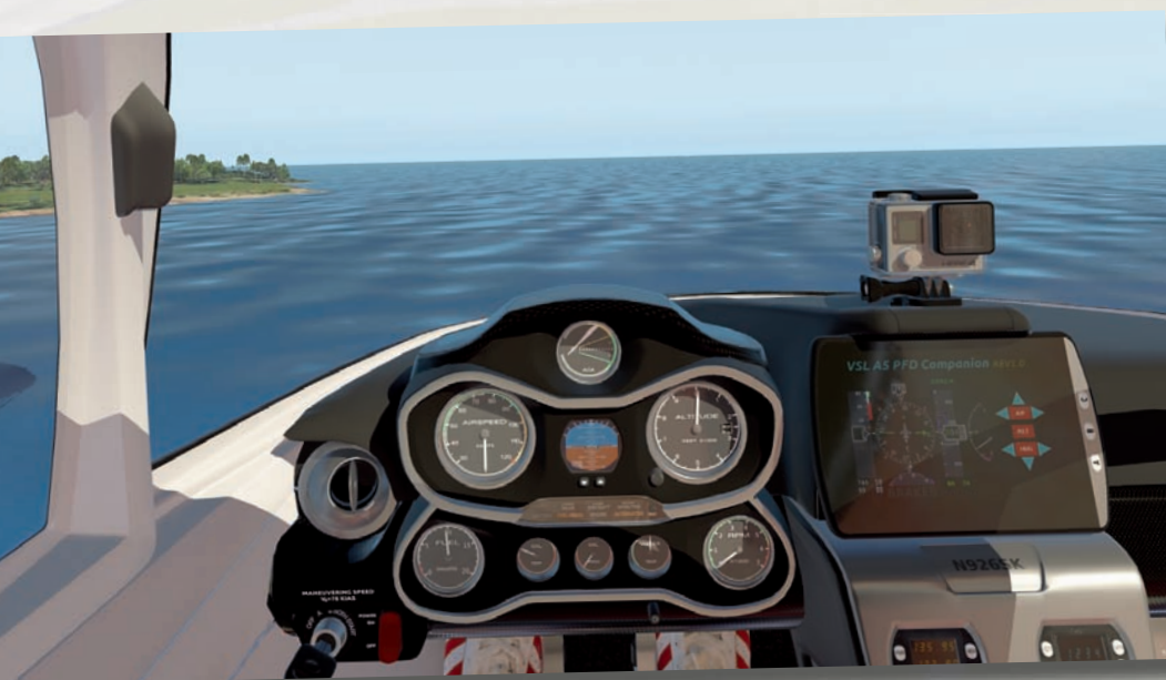
Das Cockpit der ICON-A5 verfügt über Rundinstrumente. In der Mitte die AoA-Anzeige.
