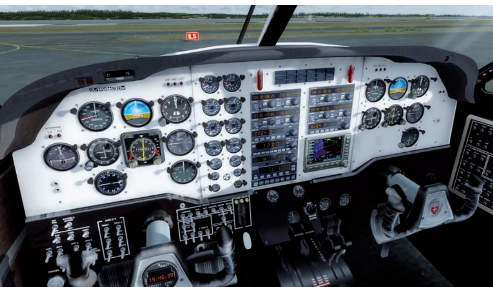
Das analoge Panel der Beech 99 ist schnell zu erlernen und einfach zu bedienen.
