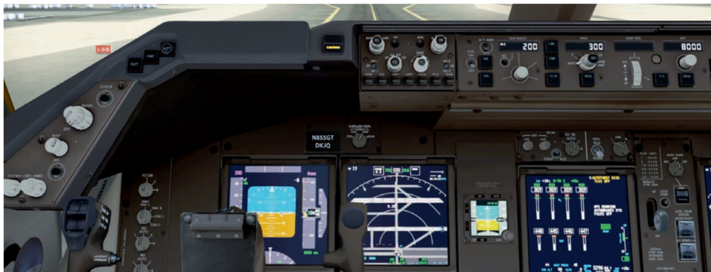
Auf dem Weg zum Start: Im Navigation Display (ND) ist das Layout des Airports Dubai als Moving Map zur besseren Orientierung eingeblendet.
