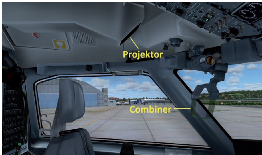
Der Einbau von Projektor und Combiner im Cockpit der Dash 8 Q400.
